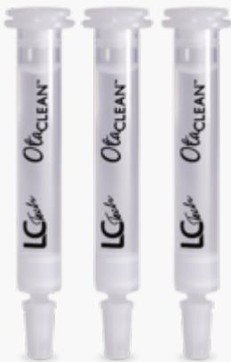
Die OtaCLEAN-Säulen sind genauso wie die AflaCLEAN und Afla-OtaCLEAN im praktischen 3 mL Polypropylen-Format oder zusätzlich als 1 mL Version erhältlich. Das Säulenbett besteht aus einem Softgel mit darüber befindlichem Lagerpuffer, der ein Konservierungsmittel enthält. Die Beladungskapazität beträgt 200 ng Ochratoxin A. Die Säulen können bei einer Temperatur von 4 °C bis 30 °C 24 Monate lang gelagert werden.
