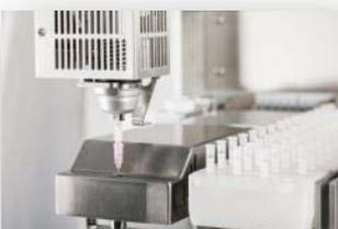
Säule wird in ThermELUTE™ Modul positioniert.
