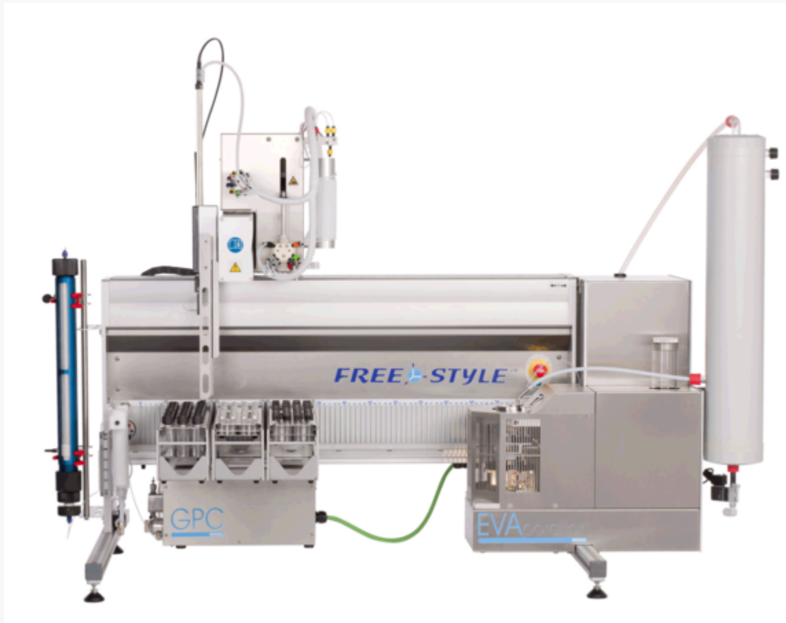
FREESTYLE System ausgestattet für die Probenvorbereitung von Pestiziden mit dem GPC- und EVAporations-Modul sowie einer kleinen Auswahl an Probenracks.
