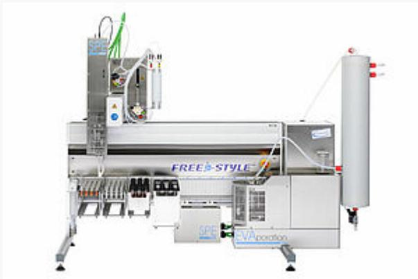
Das FREESTYLE System ist modular aufgebaut und kann abhängig von den Bedürfnissen der Nutzer mit verschiedenen Modulen, z. B. für die Festphasenextraktion (SPE-Modul), die Evaporation (EVaporations-Modul) oder die Gelpermeationschromatographie (GPC-Modul) ausgerüstet werden.
