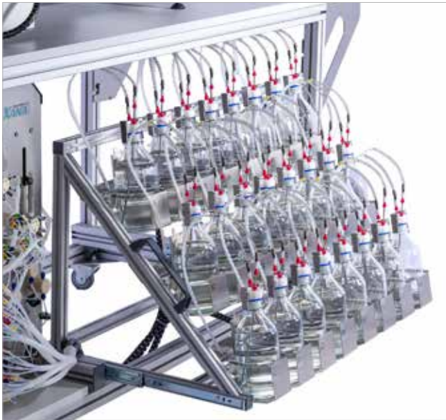
Ausziehbares Probenrack mit Platz für 24 x 1 L Probenflaschen
