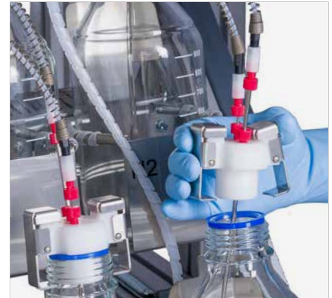
Probenflasche mit Verschluss zur einhändigen Bedienung
