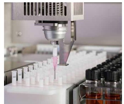
Bearbeitung auf FREESTYLE ThermELUTE™: Greifer mit Adapter nimmt SMART-Säule
