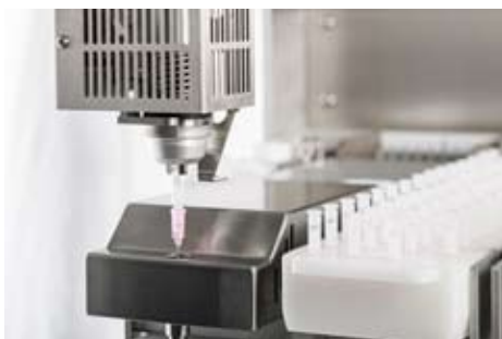
Immunoaffinitätssäule OtaCLEAN SMART wird in ThermELUTE™-Modul positioniert.
